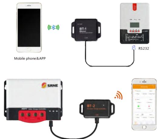
注：连接线使用标准网线（平行线）连接即可。
